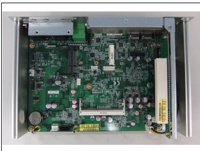
Fig. 11-3 Remove HDD kit.
